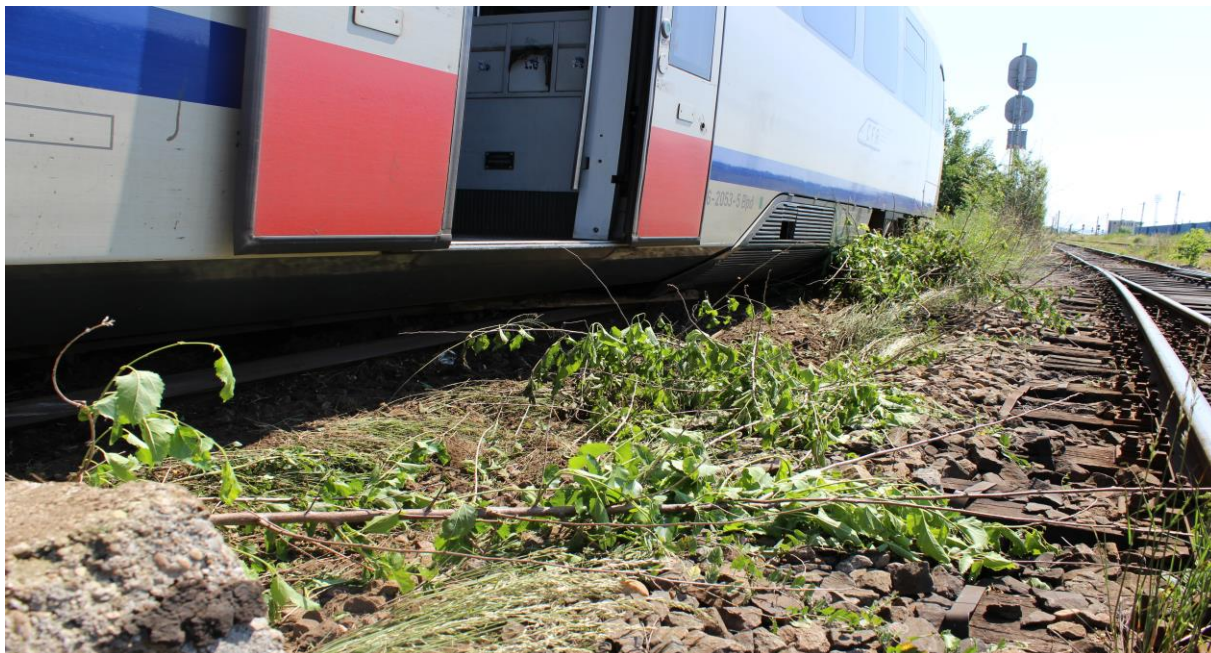
Foto 1. Poziția automotorului Desiro 2053 după deraiere
